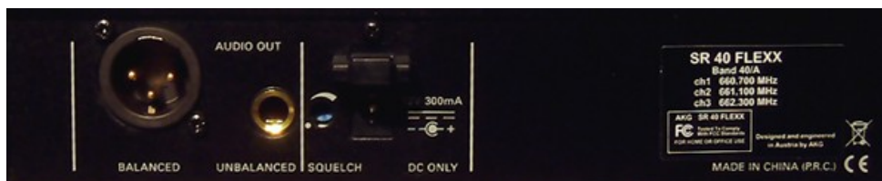
Detalle del panel trasero del receptor (salidas XLR y Jack 6,3 mm simétrico)
