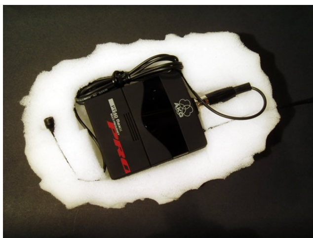
Detalles emisor (original+encapsulado en esponja blanca para adherir a los globos)
